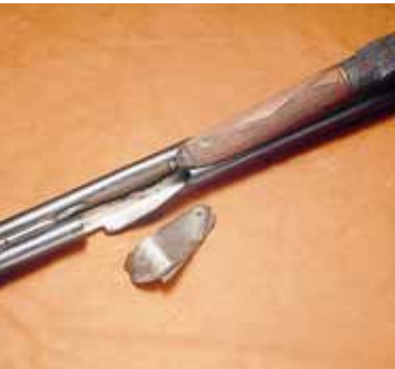
Laufsprengung als Folge einer nicht funktionssicheren Waffe
